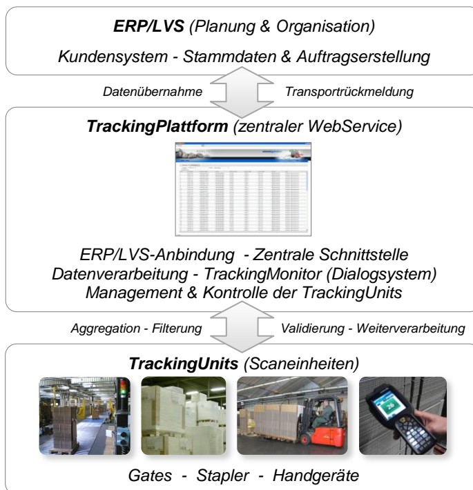
Systemaufbau : TrackingSystem als eigenständiges Subsystem (3-Ebenen-Modell)
